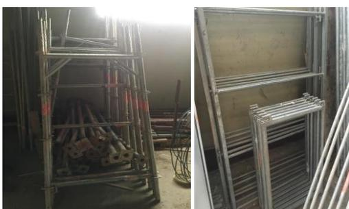
Ensemble échafaudages de marque ALTRADE acier galvanisé, 21 portiques, 31 garde-corps, 8 lisses/diagonales fixes, lot de pieds réglables, 18 montants longueur 1 mètre, 5 supports plancher, 14 plinthes et 10 plinthes d'extrémité, 64 planchers largeur 30 cm, 4 planchers alu/bois largeur 50cm, 3 échelles d'accès
